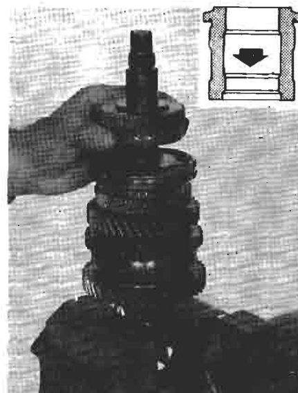
Montaggio ingranaggio condotto 4 a velocità completo di sincronizzatore e relativa boccola
