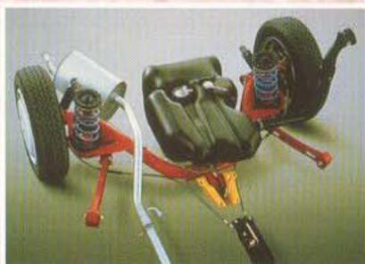
Une prise de force crabotable assure l'entraînement du pont arrière.
